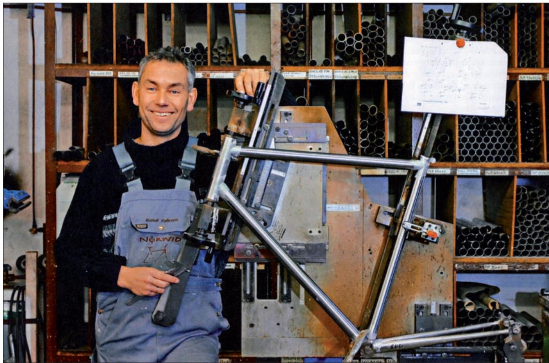
Über Umwege zum Stahl: Rudolf Pallesen an seiner Rahmenbau-Lehre; dort wird der Stahlrahmen vermessen und zum Lötten vorbereitet.
