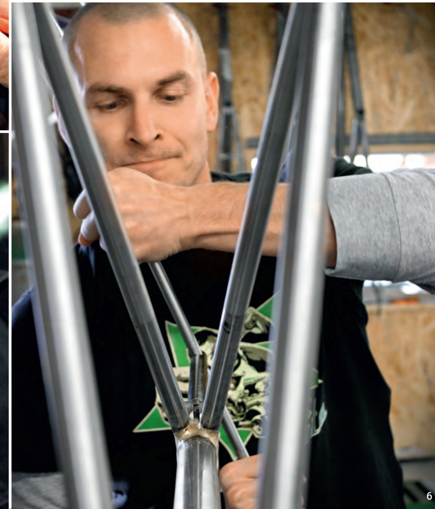
1 | Planen: Auf Basis der Fahrerermessung erstellt ein Programm den Fräsplan mit allen Längen und Winkeln, die die Rohre haben müssen, damit der Rahmen perfekt zum Fahrer passt 2 | Vorbereiten: Sämtliche Rohre werden geschliffen und poliert 3 | Heften: In der Rahmenlehre werden die Rohre in Position gebracht und dann mit einer provisorischen Naht verbunden. 4 | Lötten: Der geheftete Rahmen wird in einen Ständer gespannt und dann mit Silberlot vollgelötet. 5 | Baden: Über Nacht kommt der Rahmen in ein Wasserbad, damit sich die verglasten Flussmittelreste lösen 6 | Nachbearbeiten: Beim Ausreiben des Sitzrohrs ist sanfte Gewalt gefragt.
