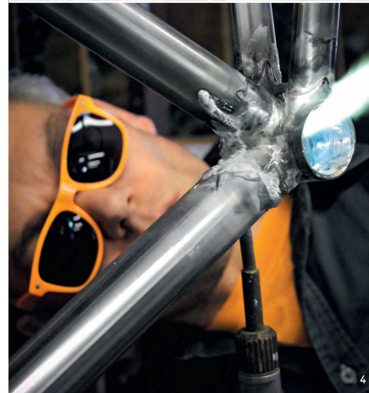
1 | Planen: Auf Basis der Fahrerermessung erstellt ein Programm den Fräsplan mit allen Längen und Winkeln, die die Rohre haben müssen, damit der Rahmen perfekt zum Fahrer passt 2 | Vorbereiten: Sämtliche Rohre werden geschliffen und poliert 3 | Heften: In der Rahmenlehre werden die Rohre in Position gebracht und dann mit einer provisorischen Naht verbunden. 4 | Lötten: Der geheftete Rahmen wird in einen Ständer gespannt und dann mit Silberlot vollgelötet. 5 | Baden: Über Nacht kommt der Rahmen in ein Wasserbad, damit sich die verglasten Flussmittelreste lösen 6 | Nachbearbeiten: Beim Ausreiben des Sitzrohrs ist sanfte Gewalt gefragt.
