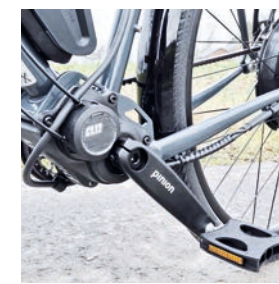
Bild oben | Feinstes Getriebe: Pinion Schaltung C1.12. Bild oben Mitte | Der Hinterradnaben-Motor Neodrive Z20. Bild ganz oben | Das Norwid Malmö X20.
